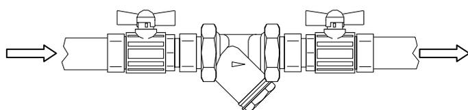
Nell'immagine si mostra come deve essere montato il filtro depuratore a Y all'interno di un circuito idraulico.
