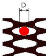
La cartuccia filtrante è l'elemento più importante del filtro. La cartuccia filtrante si presenta come un corpo cilindrico a maglie romboidali in acciaio inossidabile AISI 304.
