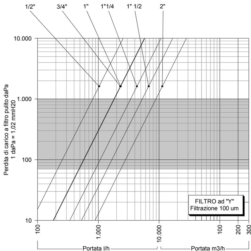
Procedimento analitico per il dimensionamento del filtro valido per liquidi con  $\rho \cong 1 \text{ kg/dm}^3$
